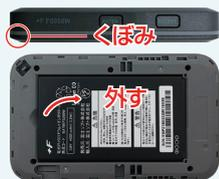
端末右側面にあるくぼみからカバーを外し、電池パックを外します。
