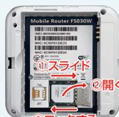
SIMストッパーを開き、SIMカードを再度取り付けます。
