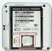
電池パックを外し、SIMカードを確認します。
