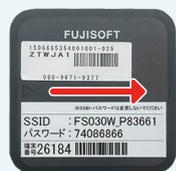
裏面を矢印方向にスライドさせて電池カバーを取り外します。
