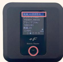
「無線LAN接続情報」が表示された状態でもう1度電源ボタンを押します。
