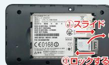
SIMスロットパーを開き、SIMカードを再度取り付けます。
