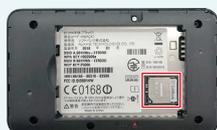
右下のSIMスロットパーにSIMカードが取り付けられているか確認します。
