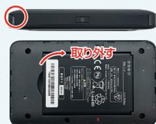
端末上部左側にあるくぼみから爪をかけてカバーを外し、電池パックを外します。
